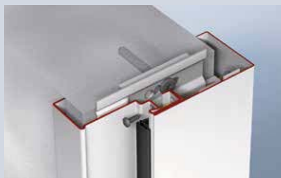
Через канавку для уплотнения соединить винтами профиль 2 доборной коробки с профилем 1 и затем вставить поверх данного соединения уплотнение двери
