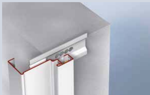
Профиль 1 угловой коробки установить и выровнять в проеме
