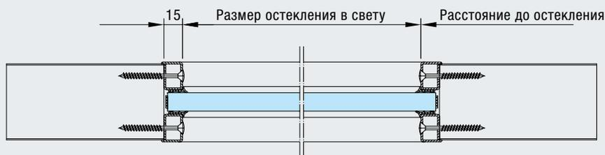
Остекление со стальным профилем, установленным заподлицо, для прямоугольного остекления (возможно только для дверей MZ и EI<sub>2</sub>30)
