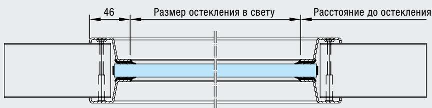
Остекление с накладным стальным профилем без видимого винтового крепления со стороны петель для прямоугольного и круглого остекления (стандарт)
